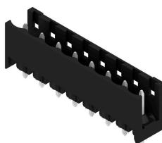
高耐熱性、直線、開いたピンヘッダー。箱もしくはテープ梱包。1.5 mm のソルダーピンを備えたテープ上で、自動機実装に最適化。リフローおよびウェーブはんだ付け適合3.2 mm ソルダーピン。ピンヘッダは、マーキングスペースがあり、識別表示が可能です。HC = 高電流。
