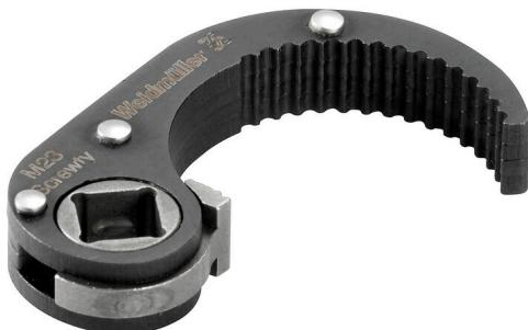
このScrewty® アタッチメントは、個別調整対応 M23 丸型プラグインコネクタや、ロール付属刻み付きナットの外寸が  $26.2 \pm 0.3$  mm の被覆成形 M23 丸型プラグインコネクタに適しています。締め付けトルクは 2 ~ 2.5 Nn です。
