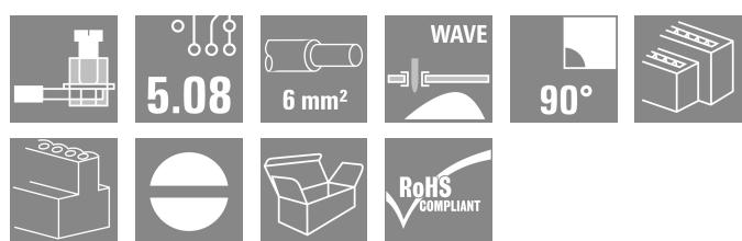
5.00 mm および 5.08 mm ピッチ、導体取り出し方向 90° の実績豊富なクランピングヨーク接続の低い単層および多段 PCB 端子。最大 6.0 mm<sup>2</sup> までの導体直径に適合。
