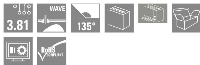
135 導体取り出し方向の SC ピンヘッダー：135 の角度は、差し込み接続方向および、ソルダーピンの間に該当します。導体取り出し方向は PCB に対して対角または 45 度になります。
