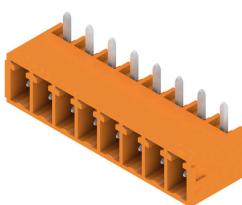
270 の取り出し方向の SC ピンヘッダー: 270 の角度は、差し込み接続方向およびソルダーピンの間に該当します。プラグ接続方向は、基板に対して平行です。ただし、ソケットブロックは基板に対して反転平行のプラグ接続角度を有します。
