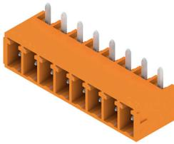
270の取り出し方向のSCピンヘッダー：270の角度は、差し込み接続方向およびソルダピンの間に該当します。プラグ接続方向は、基板に対して平行です。ただし、ソケットブロックは基板に対して反転平行のプラグ接続角度を有します。
