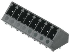
135 の導体取り出し方向を備える高耐熱性 SC-SMT ピンヘッダーは、差し込み方向とソルダピンの間に 135 の角度を有します。導体取り出し方向は PCB に対して対角または 45 になります。
