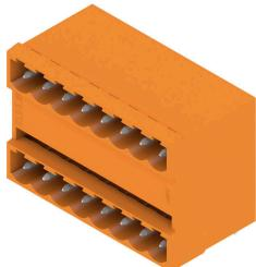
パラレルピン付属の二層オス型ヘッダー。はんだピンの長さは、フローはんだ付けに適した長さになっています。ピンヘッダーはマーキングスペースがありコード化することができます。
