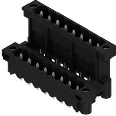
高耐熱性、二段階型、水平オフセット、フランジ付属オス型コネクタまたは、はんだフランジ。リフローはんだ付け適合 1.5 mm ソルダピン。リフローおよびフローはんだ付け適合3.2mmはんだピン。ピンヘッドは、マーキングスペースがあり、識別表示が可能です。
