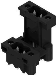
高耐熱性、二段階型、数位閉オフセット、閉鎖端部オス型ヘッダー、はんだ付けフランジオプション付属。リフローはんだ付け対応 1.5 mm ソルダーピン。リフローおよびウェーブはんだ付け適合 3.2 mm ソルダーピン。ピンヘッダは、マーキングスペースがあり、識別表示が可能です。。
