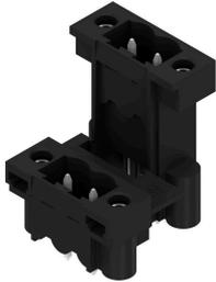
高耐熱性、二段階型、數位閉オフセット、閉鎖端部オス型ヘッダー、はんだ付けフランジオプション付属。リフローはんだ付け対応 1.5 mm ソルダピン。リフローおよびウェーブはんだ付け適合3.2 mm ソルダピン。ピンヘッドは、マーキングスペースがあり、識別表示が可能です。。
