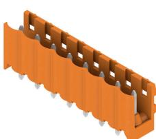
直線接続方向オス型コネクタ。はんだピンの長さは、フローはんだ付けに最適化されています。ピンヘッダは、マーキングスペースがあり、識別表示が可能です。
