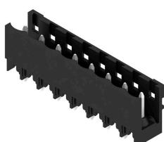
高耐熱性、直線、開いたピンヘッダー。箱もしくはテープ梱包。1.5 mm のソルダーピンを備えたテープ上で、自動機実装に最適化。リフローおよびウェーブはんだ付け適合3.2 mm ソルダーピン。ピンヘッダーは、マーキングスペースがあり、識別表示が可能です。HC = 高電流。
