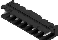
高耐熱性、90° 角度付き、開口オス型ヘッダー。箱詰め、ないしはテープの梱包。1.5 mm のソルダーピンを備えたテープ上で、自動機実装に最適化。リフローおよびフローはんだ付け適合3.2mmはんだピン。ピンヘッダは、マーキングスペースがあり、識別表示が可能です。HC = 高電流。
