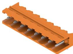
ガラスファイバー強化プラスチック製のピンヘッダーで、電線出口が90°になっており、フローはんだ付けに最適です。フランジバリエーション (F) は、各カウンターパート(コネクタ)や回路基板にネジ止めすることが出来ます。はんだフランジ (LF) バージョンを使用すれば基板への補助固定にネジ作業を必要としません。また、機械的な歪みからはんだ付け箇所を保護することもできます。すべてのピンヘッダは、マニュアルでコーディングすることも、コーディング済みのものをご注文いただくことも可能です。HC = 高電流。
