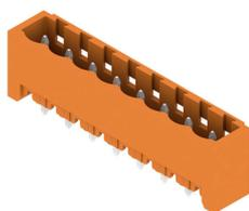
ガラスファイバー強化プラスチック製ピンヘッダ、ストレート電線引き出し口、フローはんだ付け用に最適化されています。フランジ (F) は、各相手側コネクタや回路基板とネジ固定できます。はんだフランジ (LF) バージョンを使用すれば基板への補助固定にネジ作業を必要としません。また、機械的な歪みからはんだ付け箇所を保護することもできます。すべてのピンヘッダは、マニュアルでコーディングすることも、コーディング済みのものをご注文いただくことも可能です。HC = 高電流。
