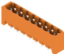
グラスファイバー強化プラスチック製ピンヘッダ、ストレート電線引き出し口、フローはんだ付け用に最適化されています。フランジ (F) は、各相手側コネクタや回路基板とネジ固定できます。はんだフランジ (LF) バージョンを使用すれば基板への補助固定にネジ作業を必要としません。また、機械的な歪みからはんだ付け箇所を保護することもできます。すべてのピンヘッダは、マニュアルでコーディングすることも、コーディング済みのものをご注文いただくことも可能です。HC = 高電流。
