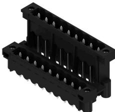
高耐熱性、二段階型、水平オフセット、フランジ付属オス型コネクタまたは、はんだフランジ。リフローはんだ付け適合 1.5 mm ソルダーピン。リフローおよびフローはんだ付け適合 3.2 mm はんだピン。ピンヘッダは、マーキングスペースがあり、識別表示が可能です。
