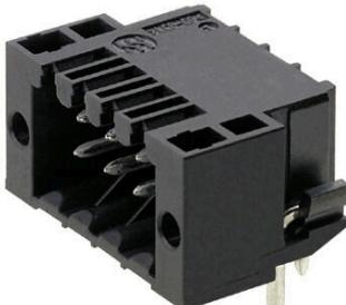
高耐熱性の直線2層オス型コネクタ。通常はんだ付け手法対応。自動実装に適した仕様です。箱梱包（BX）または静電気防止テープオンリール梱包（RL）。リフローおよびフローはんだ付け適合3.2mmはんだピン。これらのオス型コネクタは、マーキングスペースがあり、識別表示が可能です。
