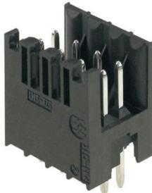
すべての通常はんだ付け手法対応の高耐熱性二列仕様ピンヘッダー。自動実装に適した仕様です。箱梱包 (BX) または静電気防止テープオンリール梱包 (RL) はんだピン長さ3.2mmでリフロー、フローはんだ付けに対応。オス型コネクタは、マーキングスペースがあり、識別表示が可能です。
