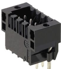
すべての通常はんだ付け手法対応の高耐熱性二列仕様ピンヘッダー。自動実装に適した仕様です。箱梱包 (BX) または静電気防止テープオンリール梱包 (RL) はんだピン長さ3.2mmでリフロー、フローはんだ付けに対応。オス型コネクタは、マーキングスペースがあり、識別表示が可能です。
