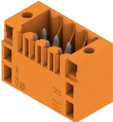
ストレート型2列ピンヘッダは、サイドクローズドタイプとフランジタイプを用意。フローはんだ工程に対応のピン長さ 3.5mm のオス型ヘッダは箱梱包で提供されます。プリント基板にネジで固定します。オス型ヘッダは、マーキングスペースがあり、識別表示が可能です。
