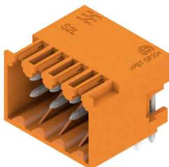
アングル型2段ピンヘッダーは、サイドクローズ型とフランジ付きがあります。3.2mmのはんだピン長は、フローはんだ付けに適しています。プリント基板にねじ止め固定されます。ピンヘッダは、マーキングスペースを提供し、コード化できます。
