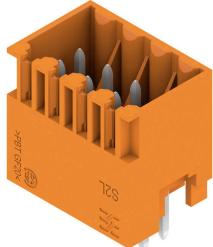
ストレート型2列ピンヘッダは、サイドクローズドタイプとフランジタイプを用意。フローはんだ工程に対応のピン長さ 3.5mm のオス型ヘッダは箱梱包で提供されます。プリント基板にネジで固定します。オス型ヘッダは、マーキングスペースがあり、識別表示が可能です。
