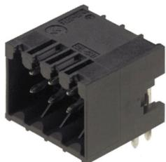
高耐熱性の直線2層オス型コネクタ。通常はんだ付け手法対応。自動実装に適した仕様です。箱梱包 (BX) または静電気防止テープオンリール梱包 (RL)。リフローおよびフローはんだ付け適合3.2mmはんだピン。これらのオス型コネクタは、マーキングスペースがあり、識別表示が可能です。
