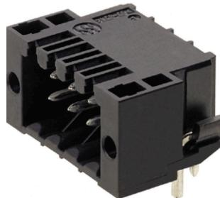
高耐熱性の直線2層オス型コネクタ。通常はんだ付け手法対応。自動実装に適した仕様です。箱梱包 (BX) または静電気防止テープオンリール梱包 (RL)。リフローおよびフローはんだ付け適合3.2mmはんだピン。これらのオス型コネクタは、マーキングスペースがあり、識別表示が可能です。
