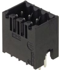
すべての通常はんだ付け手法対応の高耐熱性二列仕様ピンヘッダー。自動実装に適した仕様です。箱梱包 (BX) または静電気防止テープオンリール梱包 (RL) はんだピン長さ3.2mmでリフロー、フローはんだ付けに対応。オス型コネクタは、マーキングスペースがあり、識別表示が可能です。
