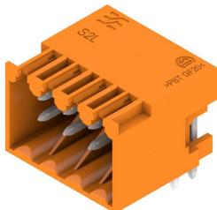
アングル型2段ピンヘッダーは、サイドクローズ型とフランジ付きがあります3.2mmのはんだピン長は、フローはんだ付けに適しています。プリント基板にねじ止め固定されます。ピンヘッダは、マーキングスペースを提供し、コード化できます。
