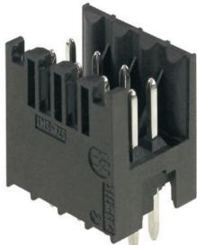
すべての通常はんだ付け手法対応の高耐熱性二列仕様ピンヘッダー。自動実装に適した仕様です。箱梱包 (BX) または静電気防止テープオンリール梱包 (RL) はんだピン長さ3.2mmでリフロー、フローはんだ付けに対応。オス型コネクタは、マーキングスペースがあり、識別表示が可能です。
