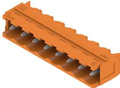
ガラスファイバー強化プラスチック製のピンヘッダーで、電線出口が90°になっており、フローはんだ付けに最適です。フランジバリエーション (F) は、各カウンターパーツ(コネクタ)や回路基板にネジ止めすることができます。はんだフランジ (LF) バージョンを使用すれば基板への補助固定にネジ作業を必要としません。また、機械的な歪みからはんだ付け箇所を保護することもできます。すべてのピンヘッダは、マニュアルでコーディングすることも、コーディング済みのものをご注文いただくことも可能です。HC = 高電流。
