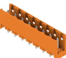
グラスファイバー強化プラスチック製ピンヘッダ、ストレート電線引き出し口、フローはんだ付け用に最適化されています。フランジ (F) は、各相手側コネクタや回路基板とネジ固定できます。はんだフランジ (LF) バージョンを使用すれば基板への補助固定にネジ作業を必要としません。また、機械的な歪みからはんだ付け箇所を保護することもできます。すべてのピンヘッダは、マニュアルでコーディングすることも、コーディング済みのものをご注文いただくことも可能です。HC = 高電流。
