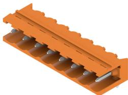
ガラスファイバー強化プラスチック製のピンヘッダーで、電線出口が90°になっており、フローはんだ付けに最適です。フランジバリエーション (F) は、各カウンターパーツ(コネクタ)や回路基板にネジ止めすることができます。はんだフランジ (LF) バージョンを使用すれば基板への補助固定にネジ作業を必要としません。また、機械的な歪みからはんだ付け箇所を保護することもできます。すべてのピンヘッダは、マニュアルでコーディングすることも、コーディング済みのもをご注文いただくことも可能です。HC = 高電流。
