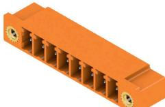
SCピンヘッダは、プリント基板に対して平行 (リカンベント) な接続が可能。サイドクローズ (G) および、ねじフランジ (F) のバージョンが使用可能。
