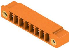
SCピンヘッダは、プリント基板に対して平行（リカンベント）な接続が可能。サイドクローズ（G）および、ねじフランジ（F）のバージョンが使用可能。ワイドミュラー 3.81mm ピッチ（0.15 インチ）のプラグインコネクタは、標準的な同タイプのコネクタとレイアウトの互換性があります。投光照明ディスプレイをサポートし、ラベリングおよびコーディング対応スペースを提供します。
