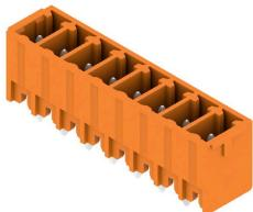
SC ピンヘッダーは、PCB に対して垂直 (縦方向) の差し込み接続方向を備えています。閉鎖状態 (G)、およびネジフランジ (F) のバージョンが使用可能。ワイドミュラー 3.81mm ピッチ (0.15 インチ) のプラグインコネクタは、標準コネクタ設計との互換性を有し、マーキングスペースがあり、識別表示が可能です。
