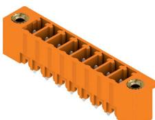
SC ピンヘッダーは、PCB に対して垂直 (縦方向) の差し込み接続方向を備えています。閉鎖状態 (G)、およびネジフランジ (F) のバージョンが使用可能。ワイドミュラー 3.81mm ピッチ (0.15 インチ) のプラグインコネクタは、標準コネクタ設計との互換性を有し、マーキングスペースがあり、識別表示が可能です。
