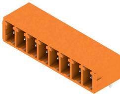
SCピンヘッダは、プリント基板に対して平行（リカンベント）な接続が可能。サイドクローズ (G) および、ねじフランジ (F) のバージョンが使用可能。ワイドミュラー 3.81mm ピッチ (0.15 インチ) のプラグインコネクタは、標準的な同タイプのコネクタとレイアウトの互換性があります。投光照明ディスプレイをサポートし、ラベリングおよびコーディング対応スペースを提供します。
