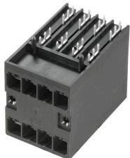
ツール不要の迅速なロックの、フランジ付属またはフランジなしの 2 列高電流高性能ピンヘッダ。幅 50 mm 以上の「ブックサイズモジュール」に最適。ハウジング壁面取り付けオプションを備えています。100% 安全な嵌合形状、独自のコーディング、フランジへのねじ止めオプションにより、優れた信頼性と操作の安全性を実現します。
