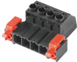
実績の豊富な 100 % メンテナンスフリーのワイドミュラーの鋼製クランプヨーク搭載の高性能オス型ヘッダ。極を損なうことなくサイドバイサイドに設置したり、特許取得済みの多機能フランジにより、工具なしで確実かつ迅速にロックすることができます。誤接続を防ぐ嵌合部構造、独自の多様なコーディング、誤配線防止機能により、接続と運用の信頼性を向上。マーキングの最適化。
