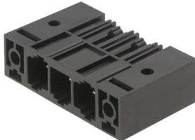
電極を犠牲にすることなく、またはツールを使わずに高速に整列状態で固定できる特許取得済みのフランジを備えた、単列で高性能なオス型ヘッダー。接合プロファイルにより、固有に識別可能なコーディング多様性およびフランジへの追加締め付けにより、誤接を防止し、接続性と動作信頼性が最大限に向上します。3.5 mm 長のピンは、ウェーブはんだ付けに対して最適化され、プラグイン方向は、ソルダーピンに対して 270° です。
