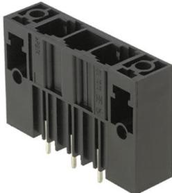
単列大電流オス型ヘッダ、極数を損なうことなくサイドバイサイド実装が可能、また、特許取得のフランジにより工具なしで素早いロックが可能です。誤接続を防ぐ嵌合構造、独自の多様なコーディング、追加固定、および一体型位置決め補助により、最大の接続性と動作信頼性を実現。3.5 mm ピン長はフローはんだ付けに最適化されており、接続方向は、はんだピンに対して180°です。
