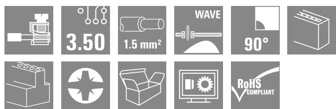
3.5 mm ピッチの板ばね接続、電線接続角度 90 の非常に
