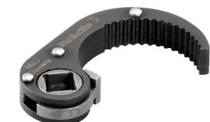
このScrewty® アタッチメントは、個別調整対応 M23 丸型プラグインコネクタや、ロール付属刻み付きナットの外寸が  $26.2 \pm 0.3$  mm の被覆成形 M23 丸型プラグインコネクタに適しています。締め付けトルクは 2 ~ 2.5 Nn です。
