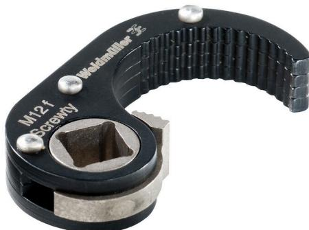
Screwty® アタッチメントは、個別調整対応 M12 丸型プラグインコネクタに適しており、刻み付きナットの外寸は  $19.8 \pm 0.3$  mm です。締め付けトルクは 0.8 ~ 1.2 Nn です。
