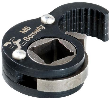
Screwty® アタッチメントは、M8 丸型プラグインコネクタに適しており、刻み付きナットの外寸は  $10 \pm 0.3$  mm です。締め付けトルクは 0.5 ~ 0.6 Nn です。
