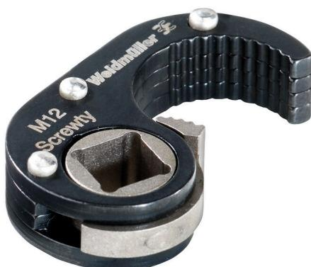
Screwty® アタッチメントは、M12 丸型プラグインコネクタに適しており、刻み付きナットの外寸は  $14.5 \pm 0.3$  mm です。締め付けトルクは 0.8 ~ 1.2 Nn です。
