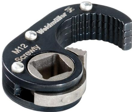
Screwty® アタッチメントは、M12 丸型プラグインコネクタに適しており、刻み付きナットの外寸は  $14.5 \pm 0.3$  mm です。締め付けトルクは  $0.8 \sim 1.2$  Nn です。
