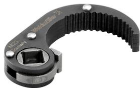
このScrewty® アタッチメントは、個別調整対応 M23 丸型プラグインコネクタや、ロール付属刻み付きナットの外径が  $26.2 \pm 0.3$  mm の被覆成形 M23 丸型プラグインコネクタに適しています。締め付けトルクは 2 ~ 2.5 Nm です。
