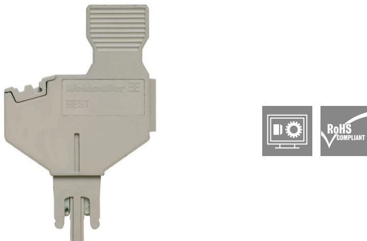
コンポーネントプラグは、電子コンポーネントを接続断路端子台に統合するために使用されます。電子コンポーネントのはんだ付け後、プラグを接続断路端子台の断路箇所に組み込むことで、断路端子台を電子コンポーネント内蔵型のモジューラー端子台に変更します。
