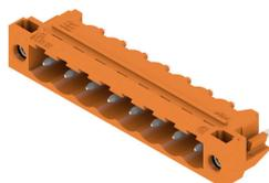
ガラスファイバー強化プラスチック製のピンヘッダーで、電線出口が90°になっており、フローはんだ付けに最適です。フランジバリエーション (F) は、各カウンターパーツ(コネクタ)や回路基板にネジ止めすることができます。はんだフランジ (LF) バージョンを使用すれば基板への補助固定にネジ作業を必要としません。また、機械的な歪みからはんだ付け箇所を保護することもできます。すべてのピンヘッダは、マニュアルでコーディングすることも、コーディング済みのもをご注文いただくことも可能です。HC = 高電流。
