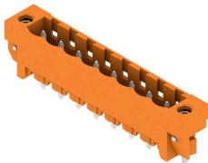
グラスファイバー強化プラスチック製ピンヘッダ、ストレート電線引き出し口、フローはんだ付け用に最適化されています。フランジ(F)は、各相手側コネクタや回路基板とネジ固定できます。はんだフランジ(LF)バージョンを使用すれば基板への補助固定にネジ作業を必要としません。また、機械的な歪みからはんだ付け箇所を保護することもできます。すべてのピンヘッダは、マニュアルでコーディングすることも、コーディング済みのものをご注文いただくことも可能です。HC = 高電流。
