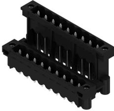
高耐熱性、二段階型、水平オフセット、フランジ付属オス型コネクタまたは、はんだフランジ。リフローはんだ付け適合 1.5 mm ソルダピン。リフローおよびフローはんだ付け適合3.2mmはんだピン。ピンヘッドは、マーキングスペースがあり、識別表示が可能です。
