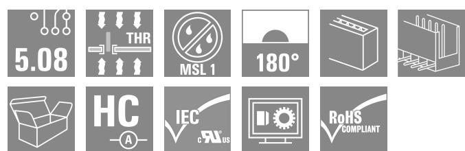
高耐熱性、直線、開いたピンヘッダー。箱もしくはテープ梱包。1.5 mm のソルダーピンを備えたテープ上で、自動機実装に最適化。リフローおよびウェーブはんだ付け適合3.2 mm ソルダーピン。ピンヘッダは、マーキングスペースがあり、識別表示が可能です。HC = 高電流。
