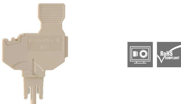
コンポーネントプラグは、電子コンポーネントを接続断路端子台に統合するために使用されます。電子コンポーネントのはんだ付け後、プラグを接続断路端子台の断路箇所に組み込むことで、断路端子台を電子コンポーネント内蔵型のモジューラー端子台に変更します。
