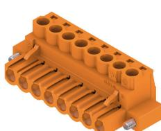
配線を直線 (180°) の接続方向に接続対応の、クランプヨークねじシステム搭載メス型プラグ。メス型コネクタは、マーキングスペースがあり、識別表示が可能です。フランジまたはリリースラッチで固定します。また、プラス/マイナスネジが組込まれたクランプヨークは、電線の誤挿入防止機能を有し、クランプは開いた状態で納入されます。HC = 高電流。
