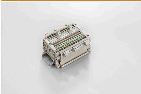
マーカ-ホルダ-は、5 または 5.1 mm ピッチの標準マーカ-を追加で取り付けすることができます。斜め型ホルダ-はオプションで一緒にスナップ可能で、Klippon® コネクトモジュラ-端子台のすべての標準マーキングチャネルに設置できます。対応マーカ-の種別は、指定印字ホルダ-の各アクセサリの下で確認できます。
