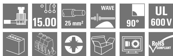
力を保持し、PCB に固定するフランジの取り付け。この PCB 端子では、101 A、1000 V、25 mm の導体直径が適用可能です。15.00 mm ピッチ、電線接続方向 90°設計の実績豊富なクランプヨーク接続。
