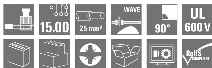
15.00 mm ピッチ、導体取り出し方向 90° 設計の実績豊富なクランピングヨーク接続の高性能 PCB 端子。バージョンおよびテストポイント。
