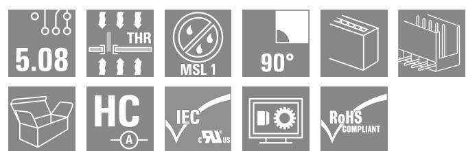
高耐熱性、90° 角度付き、開口オス型ヘッダー。箱詰め、ないしはテープの梱包。1.5 mm のソルダーピンを備えたテープ上で、自動機実装に最適化。リフローおよびフローはんだ付け適合3.2mmはんだピン。ピンヘッダは、マーキングスペースがあり、識別表示が可能です。HC = 高電流。
