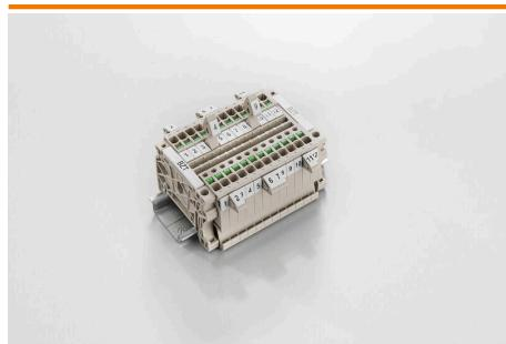
マークーホルダーは、5 または 5.1 mm ピッチの標準マークーを追加で取り付けることができます。斜め型ホルダーはオプションで一緒にスナップ可能で、Klippon® コネクトモジューラー端子台のすべての標準マーキングチャネルに設置できます。対応マークーの種別は、指定印字ホルダーの各アクセサリの下で確認できます。
