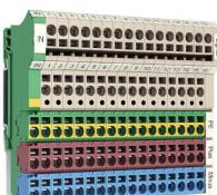
簡単な信号配線のためのモジューラーZIA分電器バーシステムは、実績のある引張ばね接続技術を備えた積み重ね可能な個々のモジュールに基づいています。統合された渡り配線とソケットおよびピン接触子の組み合わせにより、可変分配ストリップを柔軟に組み立てることができます。基本要素はTS35 DINレールにスナップするだけで、3つまたは4導体接続のさまざまな形状で利用できます。これにより、システムを個別に設定し、具体的なアプリケーションに合わせて調整できます。
