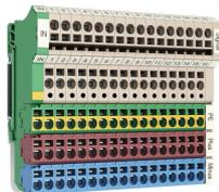
簡単な信号配線のためのモジュラーZIA分電器ベースシステムは、実績のある引張ばね接続技術を備えた積み重ね可能な個々のモジュールに基づいています。統合された渡り配線とソケットおよびピン接触子の組み合わせにより、可変分配ストリップを柔軟に組み立てることができます。基本要素はTS35 DINレールにスナップするだけで、3つまたは4導体接続のさまざまな形状で利用できます。これにより、システムを個別に設定し、具体的アプリケーションに合わせて調整できます。
