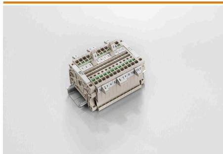
マーカーホルダーは、5 または 5.1 mm ピッチの標準マーカーを追加で取り付けることができます。斜め型ホルダーはオプションで一緒にスナップ可能で、Klippon® コネクトモジュラー端子台のすべての標準マーキングチャネルに設置できます。対応マーカーの種別は、指定印字ホルダーの各アクセサリの下で確認できます。
