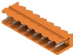
ガラスファイバー強化プラスチック製のピンヘッダで、電線出口が90°になっており、フローはんだ付けに最適です。フランジバリエーション (F) は、各カウンターパーツ(コネクタ)や回路基板にネジ止めすることができます。はんだフランジ (LF) バージョンを使用すれば基板への補助固定にネジ作業を必要としません。また、機械的な歪みからはんだ付け箇所を保護することもできます。すべてのピンヘッダは、マニュアルでコーディングすることも、コーディング済みのものをご注文いただくことも可能です。HC = 高電流。
