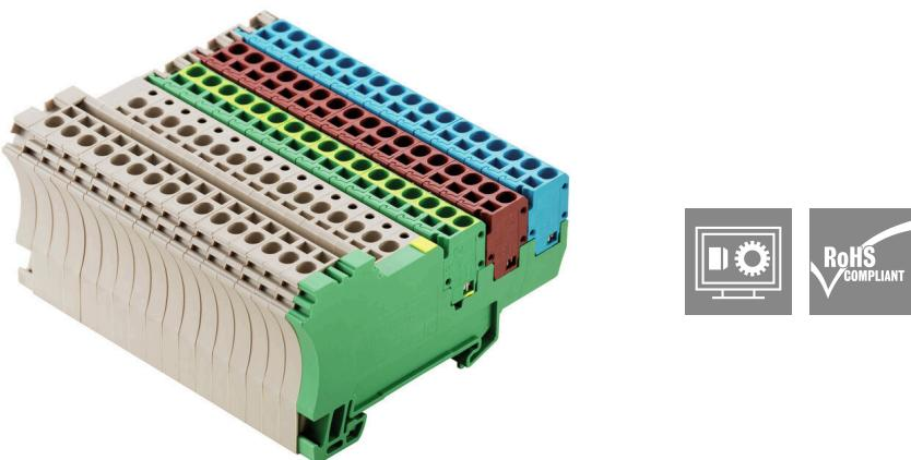
簡単な信号配線のためのモジューラーZIA分電器バーシステムは、実績のある引張ばね接続技術を備えた積み重ね可能な個々のモジュールに基づいています。統合された渡り配線とソケットおよびピン接触子の組み合わせにより、可変分配ストリップを柔軟に組み立てることができます。基本要素はTS35 DINレールにスナップするだけで、3つまたは4導体接続のさまざまな形状で利用できます。これにより、システムを個別に設定し、具体的なアプリケーションに合わせて調整できます。
