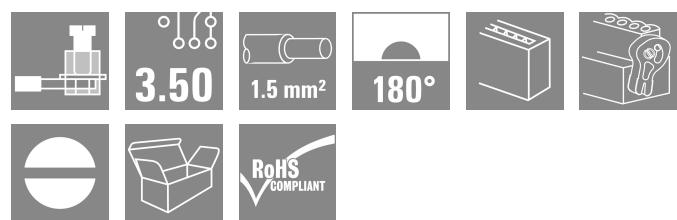
3.50mmピッチの電線接続用クランピングヨークねじ接続方式のメス型コネクタです。ピンヘッダーはマーキングスペースがありコード化することが可能です。
