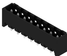
箱やテープ式梱包の高耐熱性ピンヘッダー。1.5 mm のソルダピンを備えたテープ上で、自動機実装に最適化。リフローおよびフローはんだ付け適合3.2mmはんだピン。ピンヘッダは、マーキングスペースがあり、識別表示が可能です。HC = 高電流。
