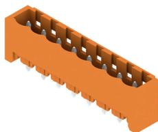
ガラスファイバー強化プラスチック製ピンヘッダ、ストレート電線引き出し口、フローはんだ付け用に最適化されています。フランジ (F) は、各相手側コネクタや回路基板とネジ固定できます。はんだフランジ (LF) バージョンを使用すれば基板への補助固定にネジ作業を必要としません。また、機械的な歪みからはんだ付け箇所を保護することもできます。すべてのピンヘッダは、マニュアルでコーディングすることも、コーディング済みのものをご注文いただくことも可能です。HC = 高電流。
