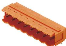
90°の取り出し方向のオス型コネクタ。はんだピンの長さは、フローはんだ付けに適した長さになっています。ピンヘッダは、マーキングスペースがあり、識別表示が可能です。
