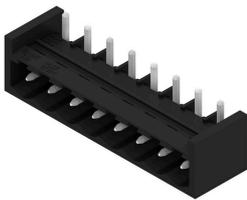
高耐熱性、直線、開いたピンヘッダー。箱もしくはテープ梱包。1.5 mm のソルダピンを備えたテープ上で、自動機実装に最適化。リフローおよびウェーブはんだ付け適合3.2 mm ソルダピン。ピンヘッダは、マーキングスペースがあり、識別表示が可能です。HC = 高電流。
