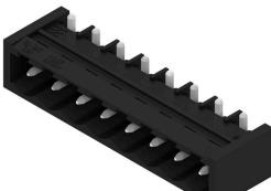
高耐熱性、直線、開いたピンヘッダー。箱もしくはテープ梱包。1.5 mm のソルダーピンを備えたテープ上で、自動機実装に最適化。リフローおよびウェーブはんだ付け適合3.2 mm ソルダーピン。ピンヘッダは、マーキングスペースがあり、識別表示が可能です。HC = 高電流。
