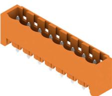
グラスファイバー強化プラスチック製ピンヘッド、ストレート電線引き出し口、フローはんだ付け用に最適化されています。フランジ (F) は、各相手側コネクタや回路基板とネジ固定できます。はんだフランジ (LF) バージョンを使用すれば基板への補助固定にネジ作業を必要としません。また、機械的な歪みからはんだ付け箇所を保護することもできます。すべてのピンヘッドは、マニュアルでコーディングすることも、コーディング済みのものをご注文いただくことも可能です。HC = 高電流。
