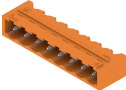
ガラスファイバー強化プラスチック製のピンヘッダーで、電線出口が90°になっており、フローはんだ付けに最適です。フランジバリエーション (F) は、各カウンターパーツ(コネクタ)や回路基板にネジ止めすることができます。はんだフランジ (LF) バージョンを使用すれば基板への補助固定にネジ作業を必要としません。また、機械的な歪みからはんだ付け箇所を保護することもできます。すべてのピンヘッダは、マニュアルでコーディングすることも、コーディング済みのものをご注文いただくことも可能です。HC = 高電流。
