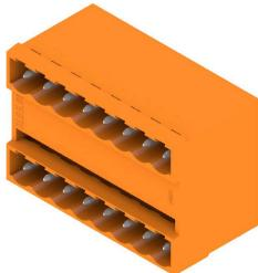
平行ピン配置の2層オス型ヘッダです。はんだピンの長さは、フローはんだ付けに適した長さになっています。ピンヘッダーはマーキングスペースがありコード化することができます。
