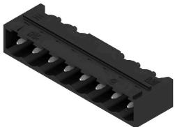
箱やテープ式梱包の高耐熱性ピンヘッダー。1.5 mm のソルダーピンを備えたテープ上で、自動機実装に最適化。リフローおよびフローはんだ付け適合3.2mmはんだピン。ピンヘッダは、マーキングスペースがあり、識別表示が可能です。HC = 高電流。
